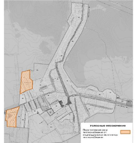
Рисунок 9 – Перспективные зоны действия систем теплоснабжения от индивидуальных тепловых источников с.п. Жигули
