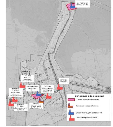
Рисунок 11 – Перспективные зоны теплоснабжения планируемых блочно-модульных источников тепловой энергии и существующих, действующих на территории с.п. Жигули
