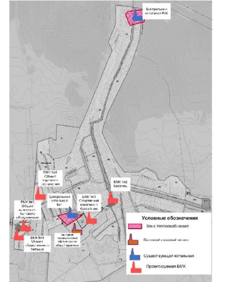
Рисунок 4 – Перспективные зоны теплоснабжения планируемых блочно-модульных источников тепловой энергии и существующих, действующих на территории с. Жигули
